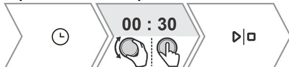
1. Ruotare la MANOPOLA per impostare il tempo di cottura desiderato. Confermare la selezione premendo la MANOPOLA. Il tempo di funzionamento del forno selezionato viene visualizzato sulla schermata.
